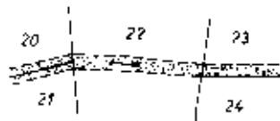
Fig. 12 - Canale di larghezza grafica superiore a 0,5 mm, che divide due particelle, poi attraversa una particella e infine costeggia una particella – Il suolo del canale appartiene alle stesse ditte delle particelle sulle quali insiste.
